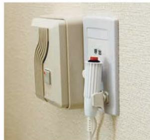
緊急通報装置
